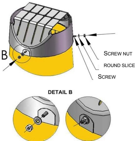
THE HEAD OF THE SCREW IS ON THE INTERIOR PART OF THE CHUTE/HOPPER. THE ROUND SLICE AND SCREW NUT ARE ON THE EXTERIOR OF THE SLOWING DOWN ELEMENT
